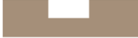
شکل ۲-۱۳: مقطع مدل شالوده در حالتی که کف چاله و شالوده هم‌تراز باشند
