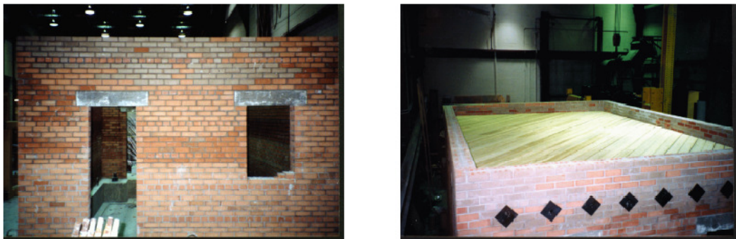
شکل ۲-۱: نمونه ساختمان بنائی غیر مسلح با مقیاس واقعی و دیافراگم چوبی با مهارهای دیوار به سقف (برانیو و پاکوت ۲۰۰۵)
