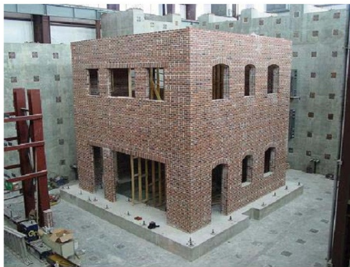
شکل ۲-۱۶: مدل سه بعدی ساختمان دو طبقه مورد آزمایش تیانایی
