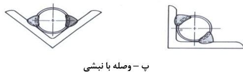
شکل ت ۴-۵ انواع اتصال با وصله جانبی
