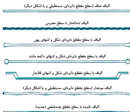
شکل ت ۳-۱ شکل برخی انواع الیاف
