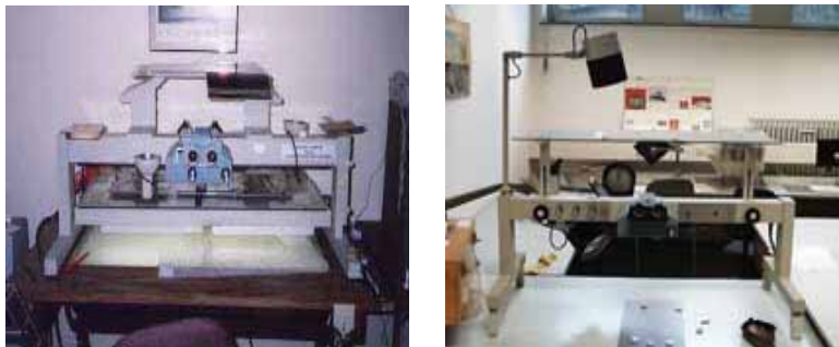
شکل ۲-۲: دستگاه‌های زوم ترانسفرسکوپ سمت راست و زوم استریوترانسفرسکوپ سمت چپ جزئیات ویژگی‌های پدیده‌های ثبت شده در تصاویر ماهواره‌ای به وسیله دستگاه‌های مزبور بر روی نقشه‌های مبنا پیاده می‌شود.
