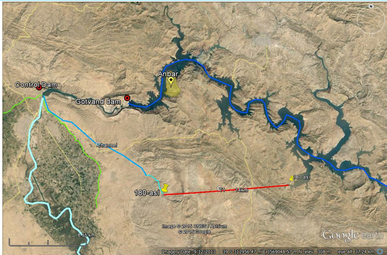
شکل ۹-۳- مسیر انحراف رودخانه با استفاده از بدنه سد گتوند
