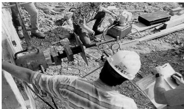
شکل ۱-۸: دستگاه آزمایش بار میخ
