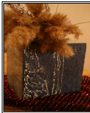
شکل ۶ : بتن شفاف با بهره گیری از فیبرهای نوری
