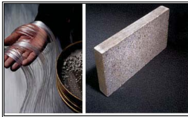
شکل ۱: فیبر نوری و بلوک نیمه سازه ای سو گذران (نیمه شفاف)
