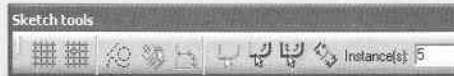
شکل ۳-۴۱۴ وارد کردن مقدار در قسمت Instance(s) و برای تعداد تکرارهای حاصل از فرمان Offset
