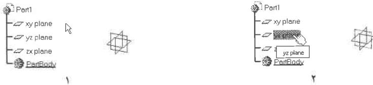
شکل ۲۰-۳ شکل نشانگر ماوس قبل (۱) و بعد (۲) از قرار گرفتن بر شاخه‌های درخت طراحی
