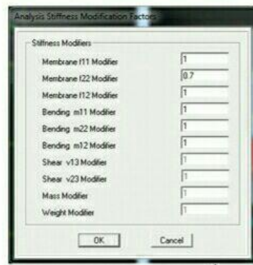
مشخصات دیوار ترک نخورده
