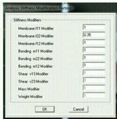
مشخصات دیوار ترک خورده
