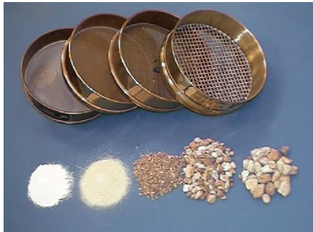
شکل ۱-۱۵ آزمایش دانه بندی مکانیکی با استفاده از سری الک
