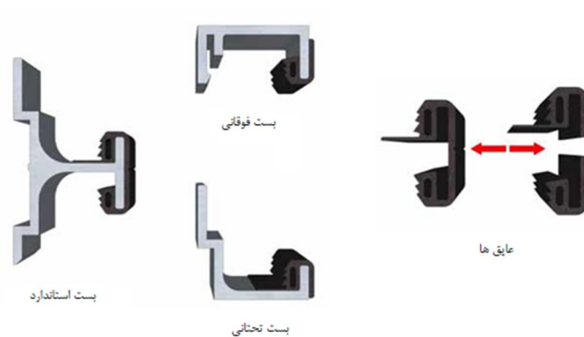
شکل ۷-۱۱- نصب درزپوش بر روی بست‌ها
