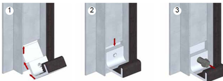
شکل ۷-۱۲- نحوه نصب بست‌ها بر روی ریل
