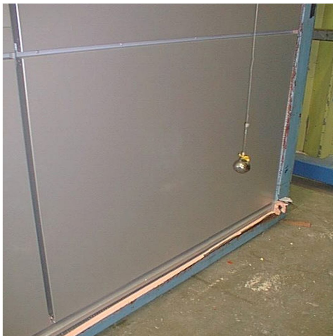
شکل ۳-۳- انجام تست ضربه جسم سخت بر روی نمای کامپوزیت
