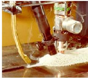
**اصول کار :** در جوشکاری زیر پودری ، انتهای سیم جوش یکسره در داخل توده انباشته روان ساز ، که منطقه یا اتصال مورد جوش را می پوشاند ، قرار می گیرد. قوس توسط برخورد الکتروود به سطح قطعه کار آغاز می گردد.
