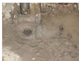
مقاومت فشاری بتن با مغزه گیری از اعضاء سازه
