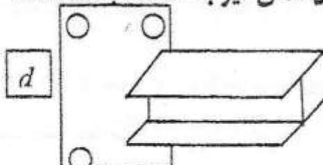
الف) در صورت استفاده از پیچهای اصطکاکی برای اتصال تیر به ستون باید انتظار داشت که اتصال به صورت نیمه گیردار عمل نخواهد کرد.
