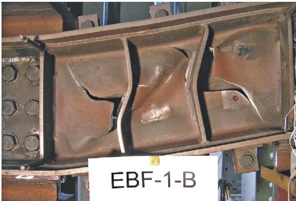
گسیختگی پس از کمانش سخت کننده های تیر پیوند
