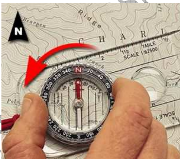
شکل ۱۱- توجیه نقشه با استفاده از قطب نما
