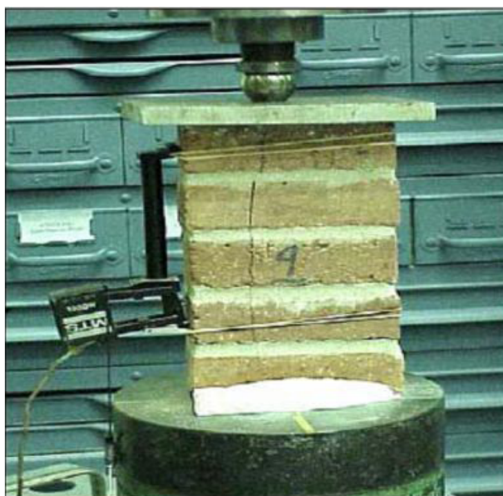
شکل (۲-۴): آزمایش تنش فشاری مصالح بر روی نمونه [۸]
