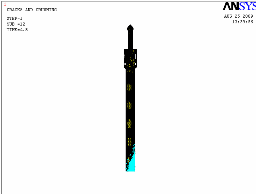
شکل (۶-۲۳): شروع ترک خوردگی مناره در ثانیه ۴/۸ بعد از مقاوم سازی با دو لایه FRP
