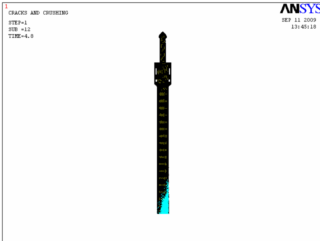
شکل (۶-۲۴): شروع ترک خوردگی مناره در ثانیه ۴/۸ بعد از مقاوم سازی با چهار لایه FRP
