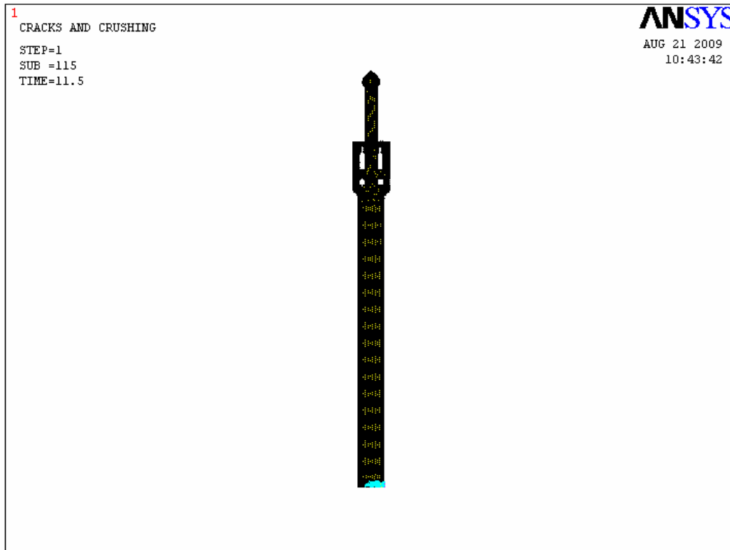
شکل (۶-۹): شروع ترک خوردگی مناره در ثانیه ۱۱/۵ قبل از مقاوم سازی
