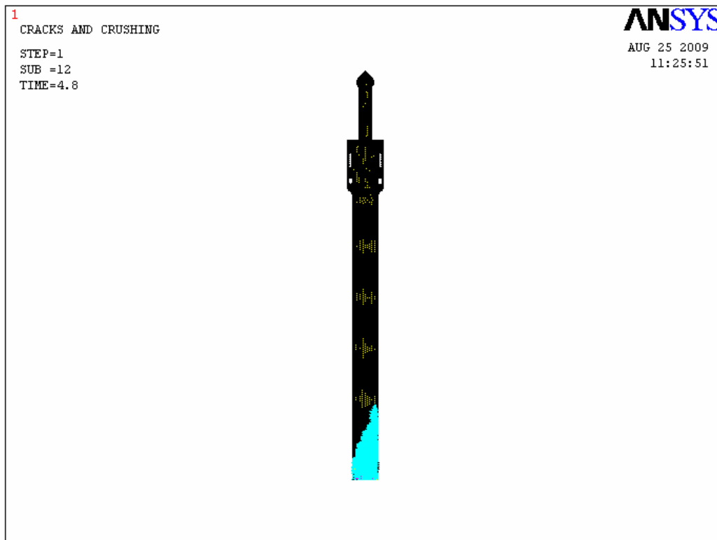
شکل (۶-۲۲): شروع ترک خوردگی مناره در ثانیه ۴/۸ قبل از مقاوم سازی
