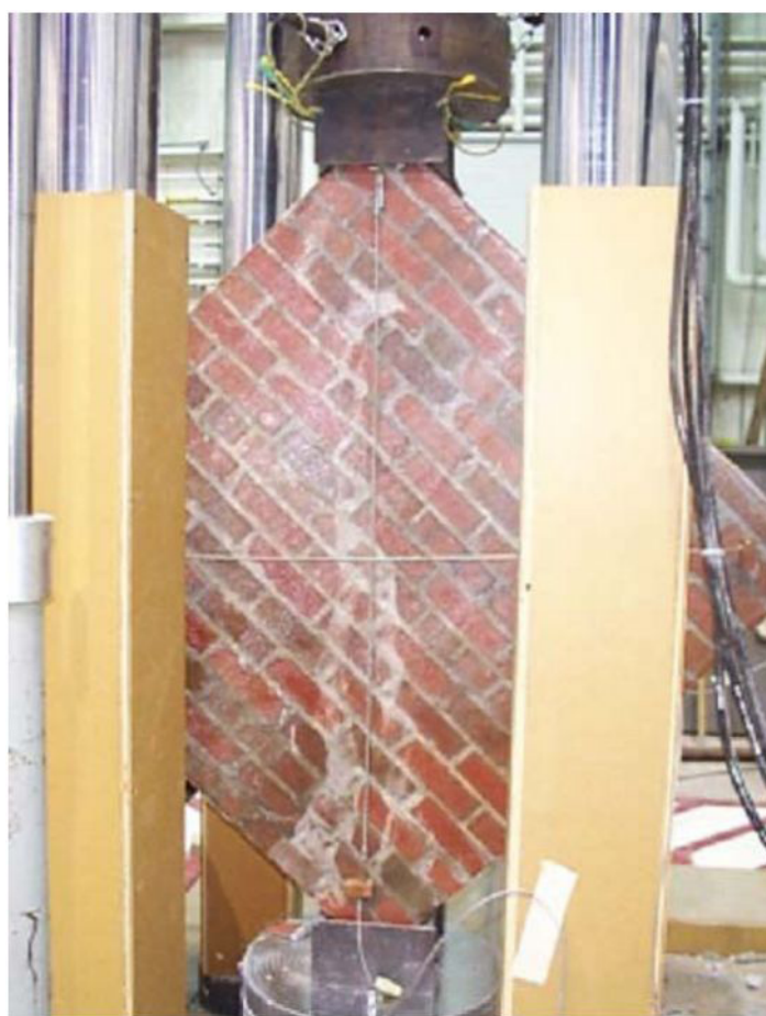
شکل (۲-۱۰): آزمایش فشار قطری [۸]
