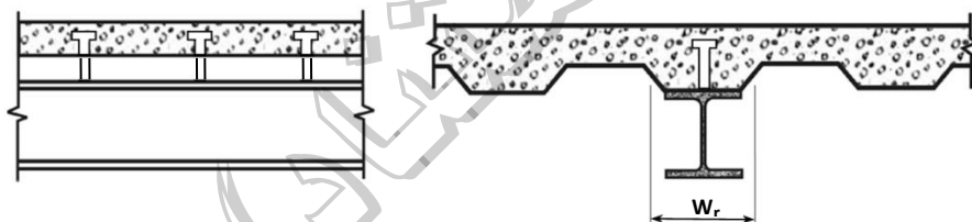
شکل ۸-۲-۱۰-۹: عرشه فولادی که کنگره‌های آن‌ها موازی با محور تیر است
