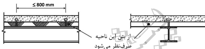
شکل ۸-۲-۱۰-۸: عرشه فولادی که کنگره‌های آن‌ها عمود بر محور تیر است
