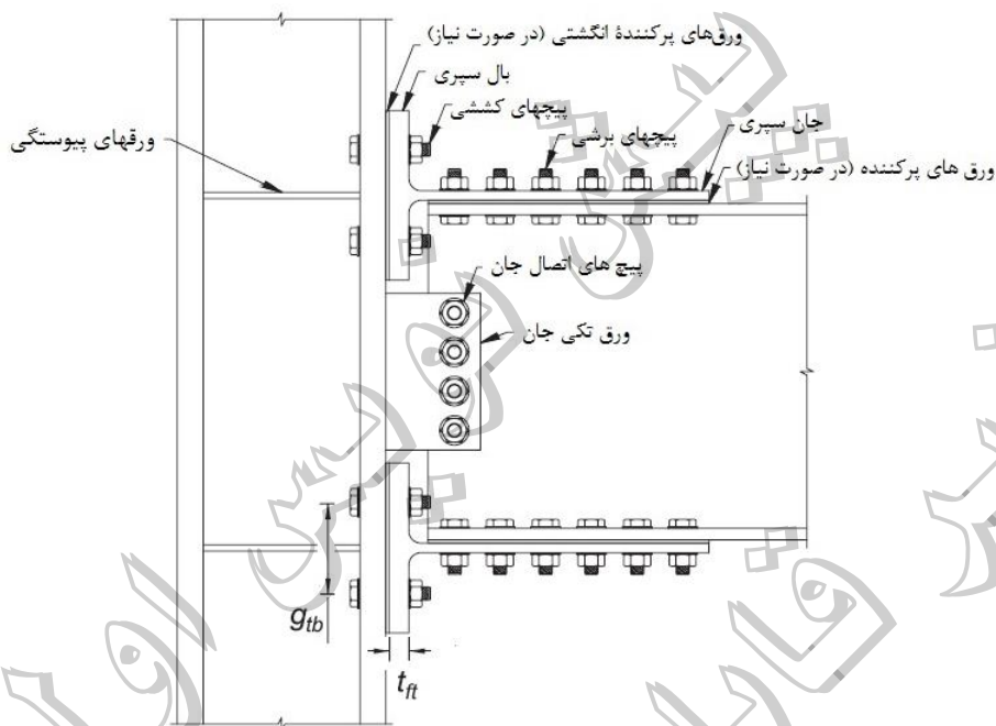
شکل ۱۰-۷-۳-۸: اتصال گیردار پیچی با جفت سپری (DT)
