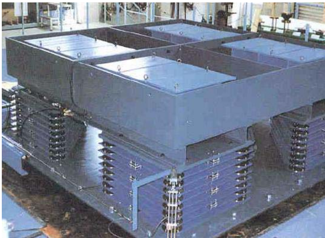
شکل (۷) - TMD - برج Ten Bosch در ناگاساکی
